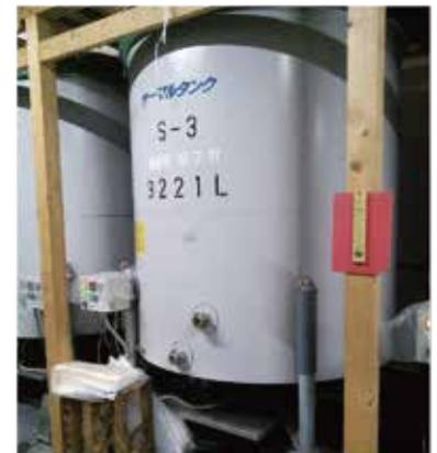
写真：冷却装置付きタンク
